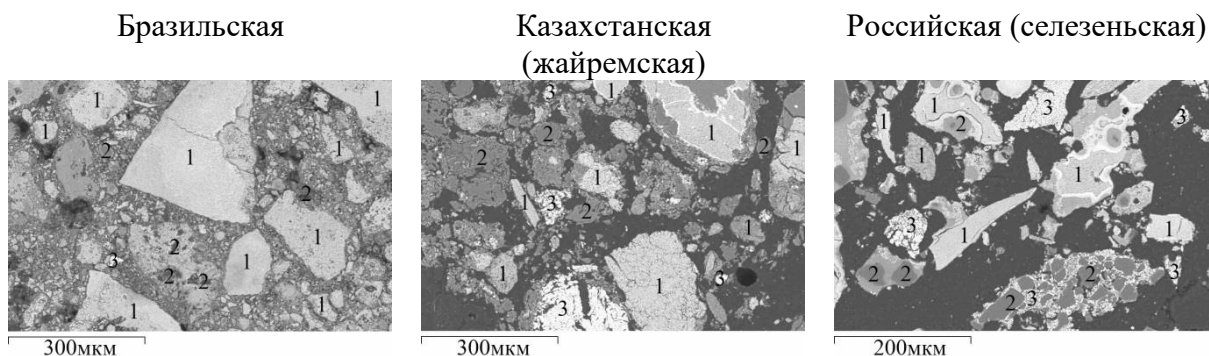
Рисунок – Вид восстановленных водородом образцов (900 °С, продувка 30 мин.)
