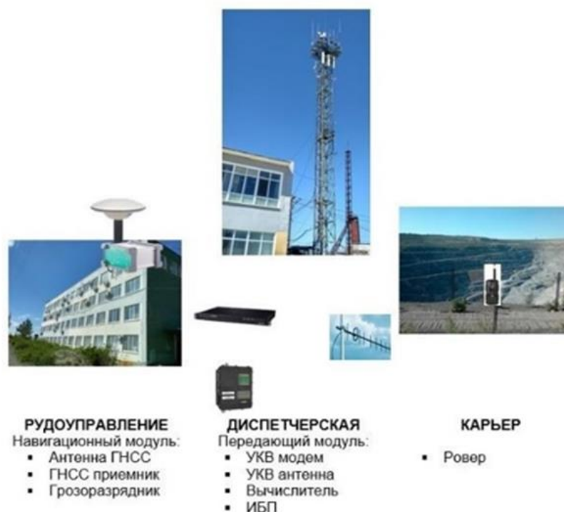
Рисунок 1 – Расположение модулей базовой станции дифференциальной коррекции
