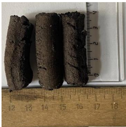
Рисунок 1 – Сырые брикеты экструзионные из пыли ЭДП с оптимальным содержанием влаги
