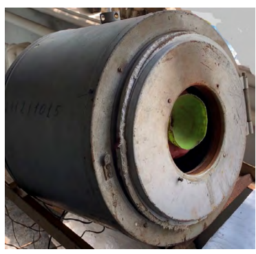
Рис. 1 – Реактор для выщелачивания в лабораторных условиях
